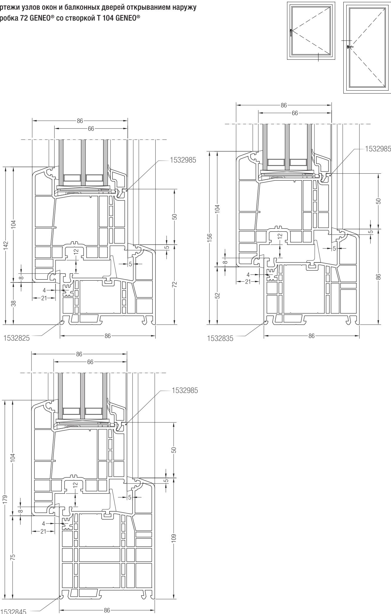
Чертежи узлов окон и балконных дверей открыванием наружу
