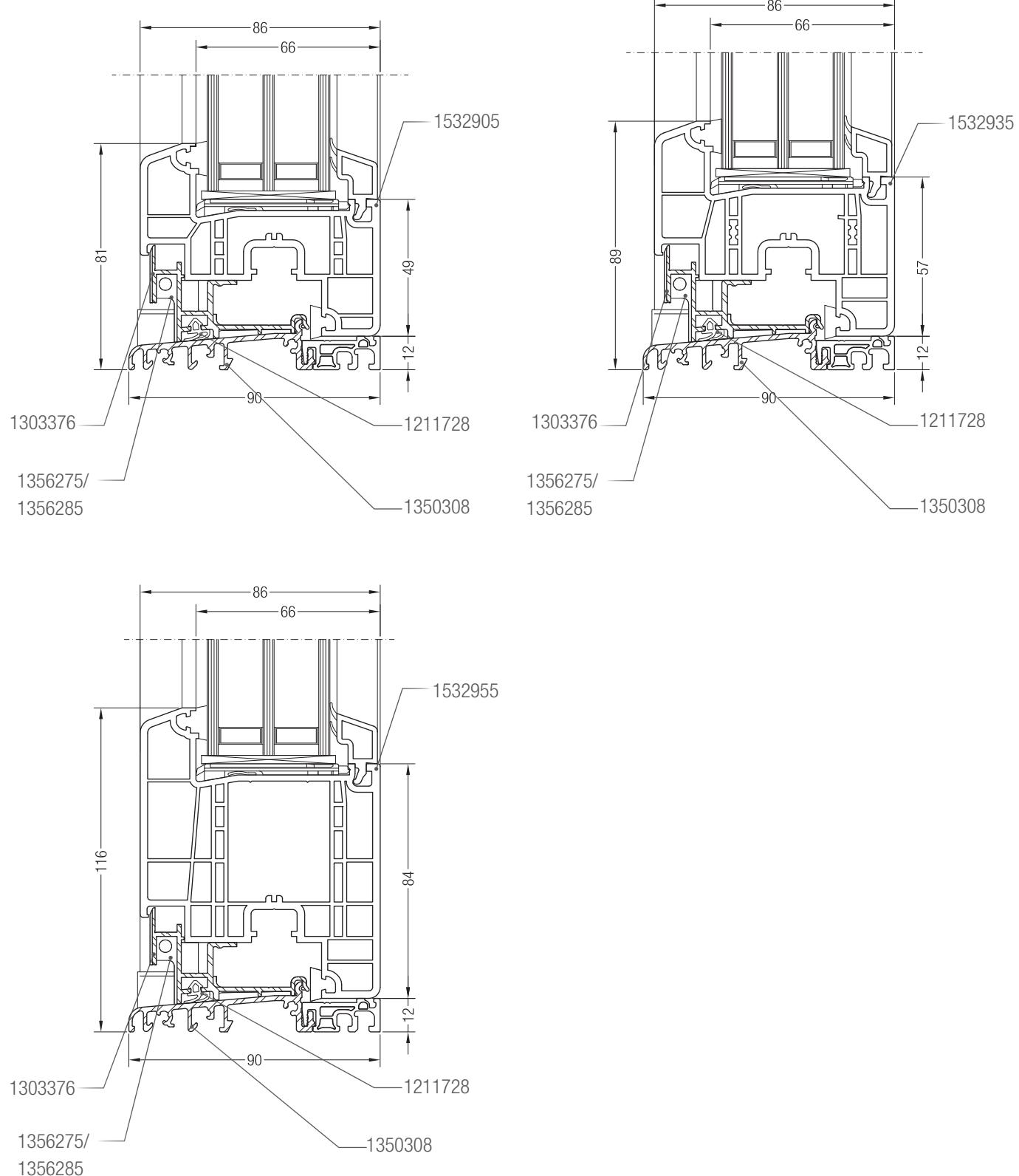
Чертежи узлов окон и балконных дверей открыванием наружу
