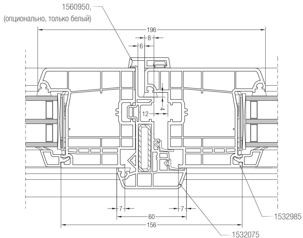
Чертежи узлов окон и балконных дверей открыванием наружу
