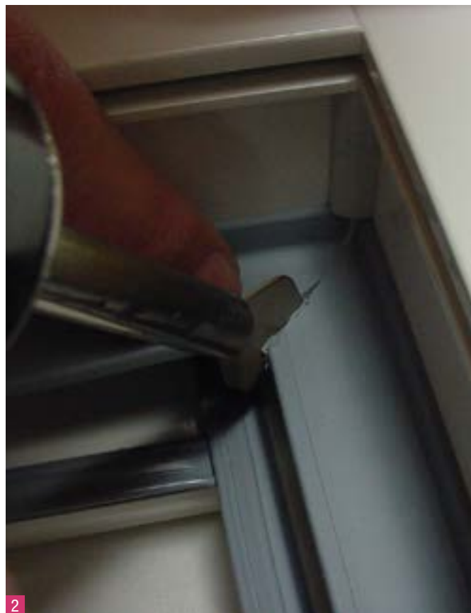
Передняя часть уплотнений расплавляется при температуре ок. 250-270 °C в течение 3 сек.
