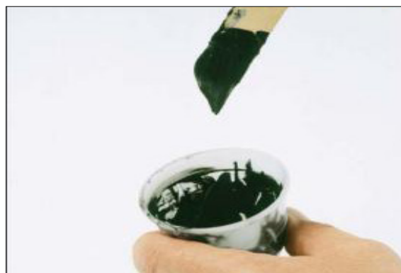
Рис. 14: материал демонстрирует поведение резины: время жизнеспособности завершилось.
