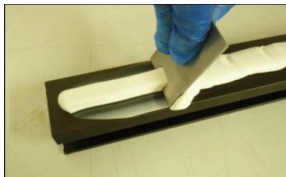
Рис. 15: сглаживание клея с помощью ракеля.
