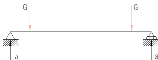
Рисунок 13: расчётная схема по собственному весу
