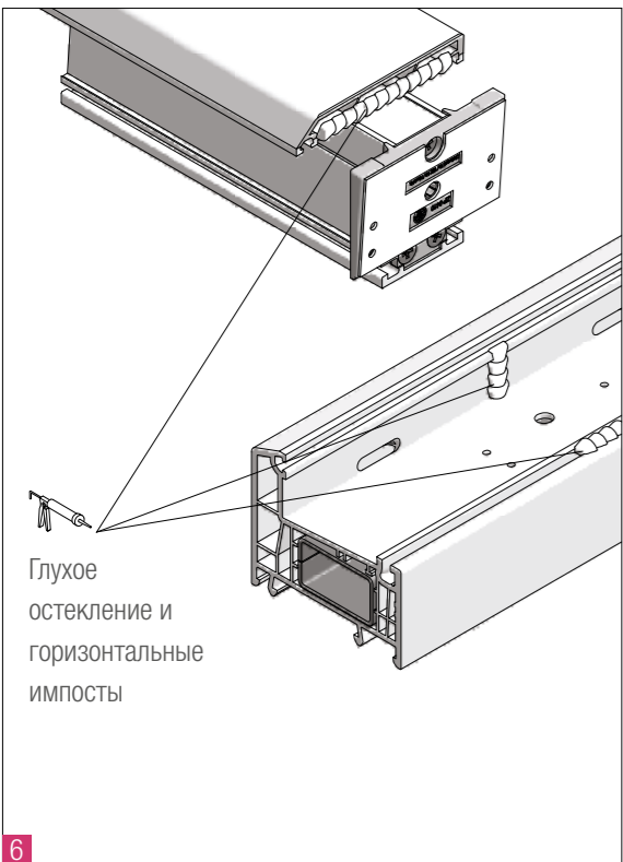
6 Герметизировать силиконом области наплава и паза штапика (в случаях установки горизонтальных импостов, либо при исполнении глухого остекления).
