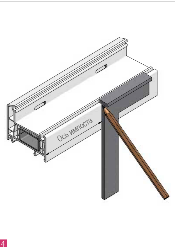
4 Разметить положение оси импоста (по возможности \geq 400 мм).
